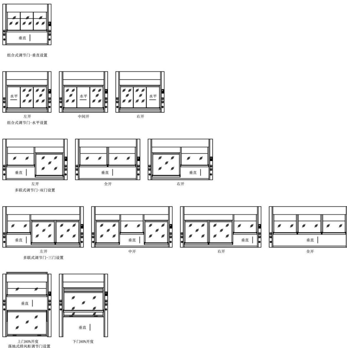
图 A.1 排风柜柜门试验操作开口设置
